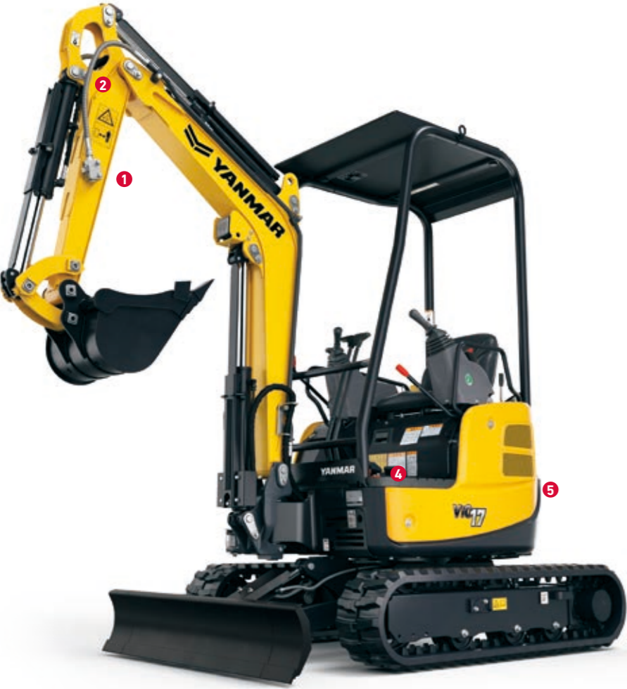
4柱キャノピー仕様(ROPS/FOPS基準※)
