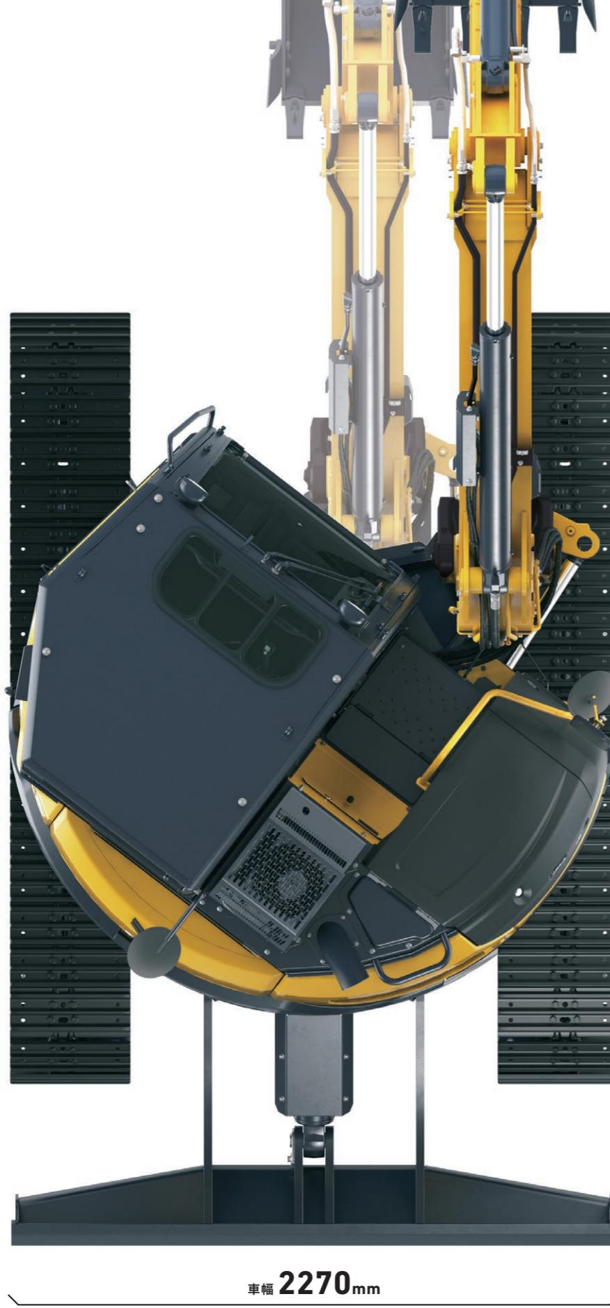
後方を気にせず旋回。後方超小旋回
