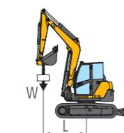
※右表に示す定格荷重は、水平堅土上定置荷役における値で、転倒荷重の78%以内、および移動式クレーン構造規格で定める前方安定度を満足するものです。
