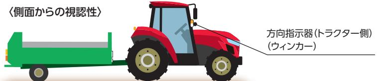
※農耕トラクターと作業機(けん引タイプ)の連結状態で農耕トラクターの側面から方向指示器の灯火が確認できる必要があります。
