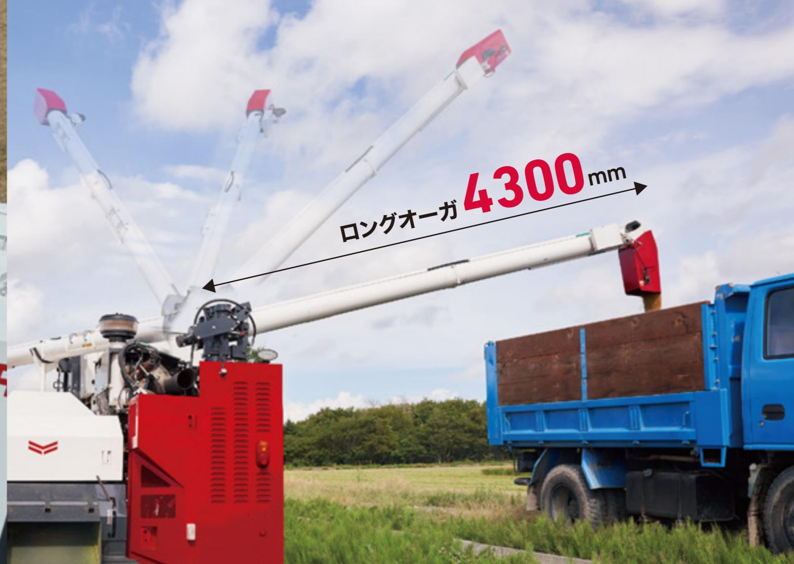
シンプルな操作でコンテナへの均一排出が確実にできる
