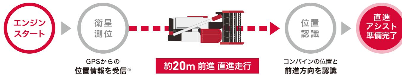
※DGNSS 5分程度、RTK 2~3分程度
