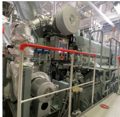
【船内のメタンスリップ削減システム (左：EGR※ 2 システム、右：メタン酸化触媒層)】
