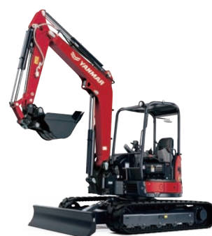
4柱キャノピー仕様 (ROPS※1/FOPS※2基準)
