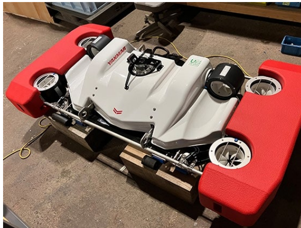
<ヤンマーグループで開発中の船底洗浄 ROV>
