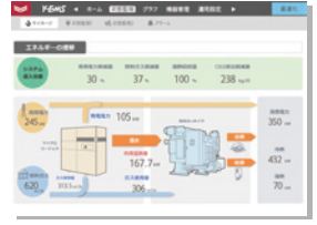
エネルギー使用量・廃熱利用量・ 発電量などを直感的に見える化
