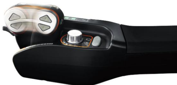
<無段変速トランスミッション「I-HMT」を操作する変速レバーイメージ>
