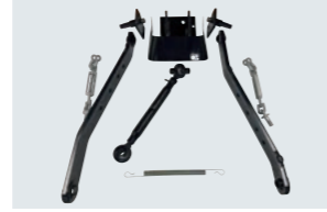
■ リンクSET (スリーポイントヒッチ) リンク(3P/X)SET 1A7370-14400(U仕様用) リンク(3P/O3)SET 1A7370-13970(U仕様以外用)
