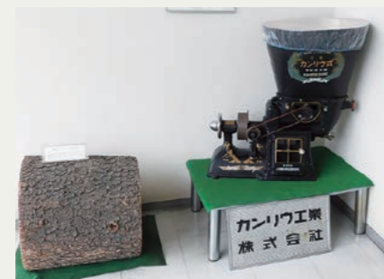
同社の玄関に飾られた往年の還流式精米機。当時は動力部がなく、水車等につないで動かしていた。
