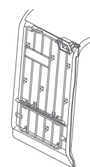
4柱キャノピー仕様 (ROPS※1/FOPS※2基準)
